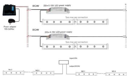
instalar la fuente de alimentación en el medio para evitar caídas de tensión
