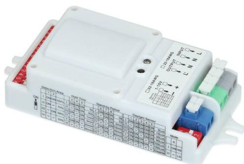
El Sensor de movimiento Merrytek MC083V-RC dispone de una innovadora tecnología de detección con sistema HF de 5.8GHz que permite que el movimiento pueda ser detectado a través de distintos materiales como plástico, vidrio y materiales no metálicos delgados.
